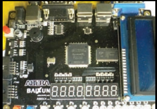
Рис. 2. Отладочная плата на базе ПЛИС Altera
